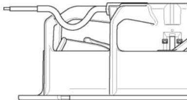
*Иллюстрация 1: Установленный в лежачем положении вентилятор, прокладка кабеля в виде водяного мешка.*
