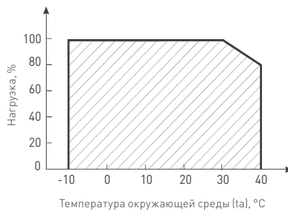
Рис. 2. Максимальная допустимая нагрузка, % от мощности источника.
