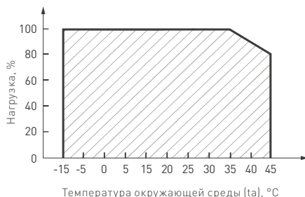
Рис. 2. Максимальная допустимая нагрузка, % от мощности источника.
